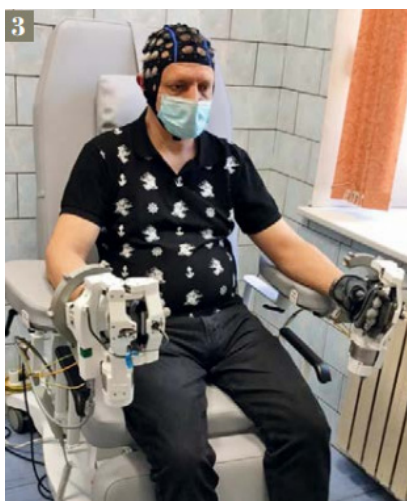
Рис. 2. Выполнение реабилитационных упражнений с помощью экзоскелета «Экзокисть-3», управляемого через ИМК
